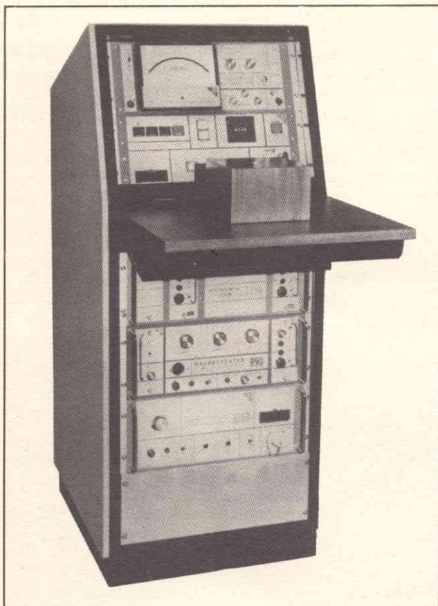
Fig. 35 - Un sistema magnetico completo Magnetreater®, che carica, misura e stabilizza i materiali magnetici (RFL).
