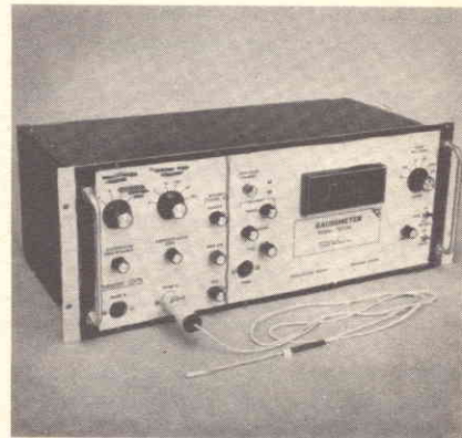
Fig. 5 - Gaussmetro RFL (Vianello) modello 750DR, in versione rack, con adattatore ID75.
